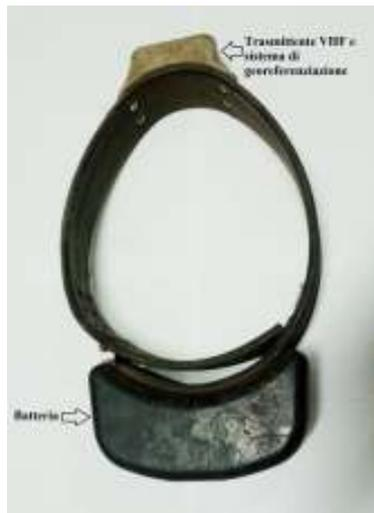
Figura 16: radiocollare Vectronic Aerospace GmbH
