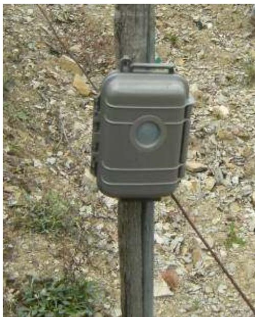
Il sensore remoto è un dispositivo che dialoga wireless con il DAF e permette di far partire lo strumento al passaggio di animali a distanza di circa 100 metri dal DAF.
